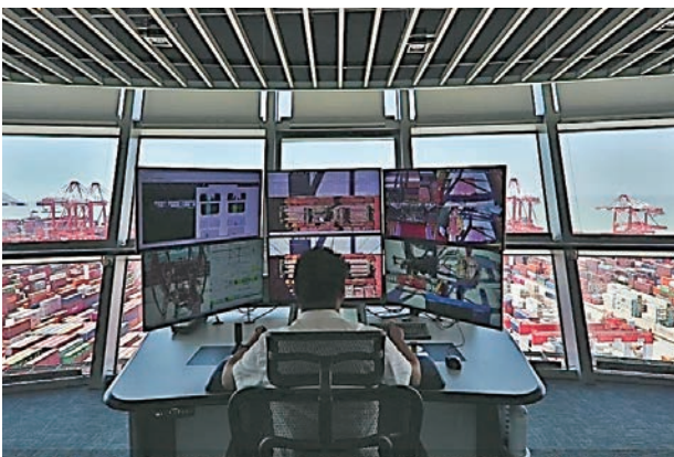
ビル内にあるガントリークレーンの運転室 (出典：洋山四期パンフレット)
